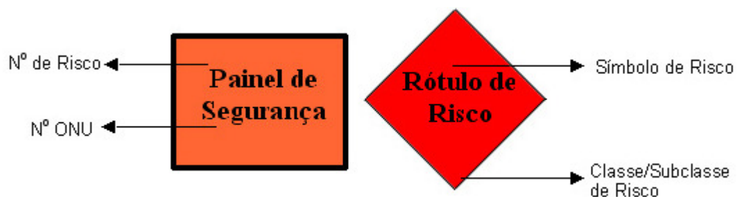
FIGURA 3 - Identificação de segurança no painel de segurança e rótulo de risco
