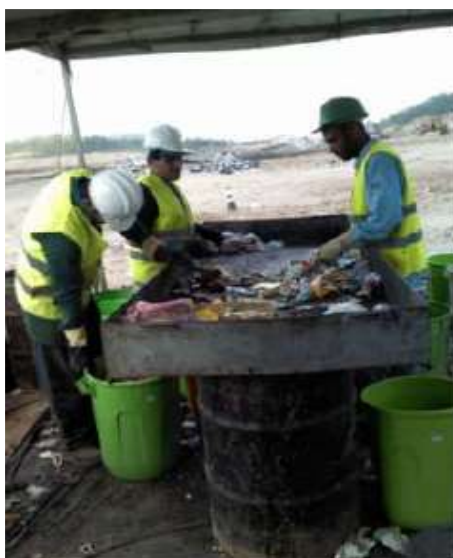
Foto 3: Execução da triagem do RSU
