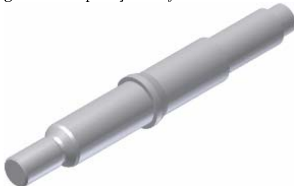
Figura 10 – Aplicação das features dos chanfros
