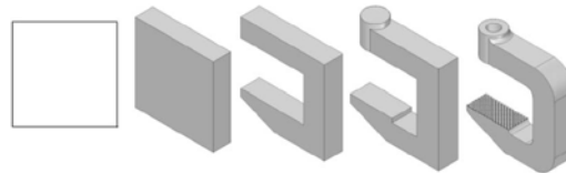
Figura 4 - Modelagem a partir de geometria simples
