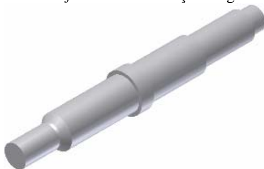
Figura 9 - Primeira feature da revolução da geometria inicial
