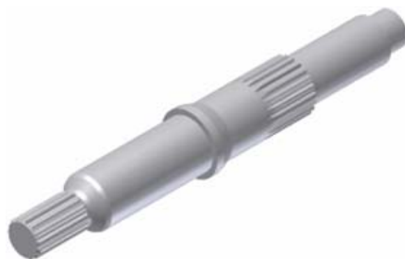
Figura 11 - Estrias modeladas pelo acelerador de projetos
